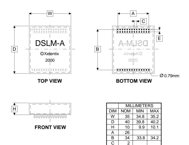
Figure 3. Module dimensions
